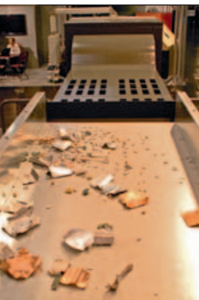
Die Sortiereinheit EX900 erkennt Metalle und schleust sie mit dem Verfahren der Planaren Magnet-Induktions-Tomographie aus. Foto: M.Boeckh
