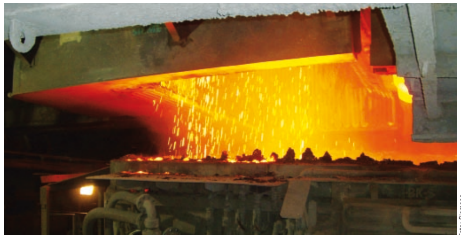
Siemens-Verfahren: Lichtbogen und Stahlbad immer optimal mit Schaum Schlacke bedeckt
